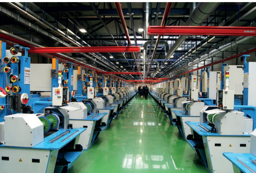
Podvsný modulární systém KBK pomáhá při výrobě patních lanek a kordů.
