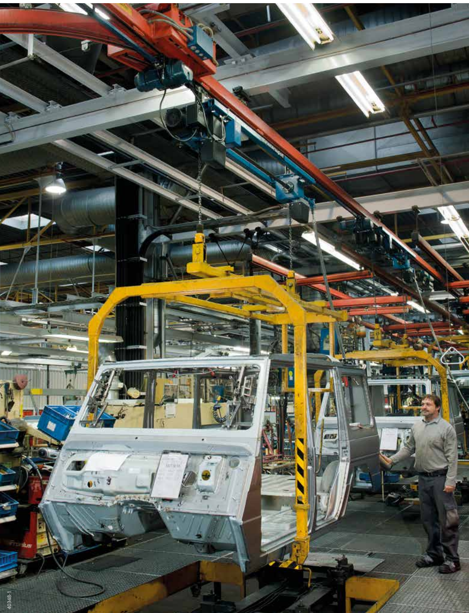
Transport nadwozi przy pomocy dwóch wciągników łańcuchowych LDC-D sprzężonych ze sobą mechanicznie
