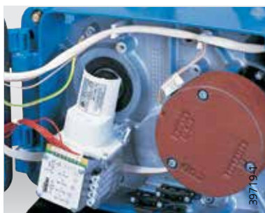
Przekładniowy wyłącznik krańcowy GGS z maks. 8 zestykami do wyłączania w zdefiniowanych pozycjach
