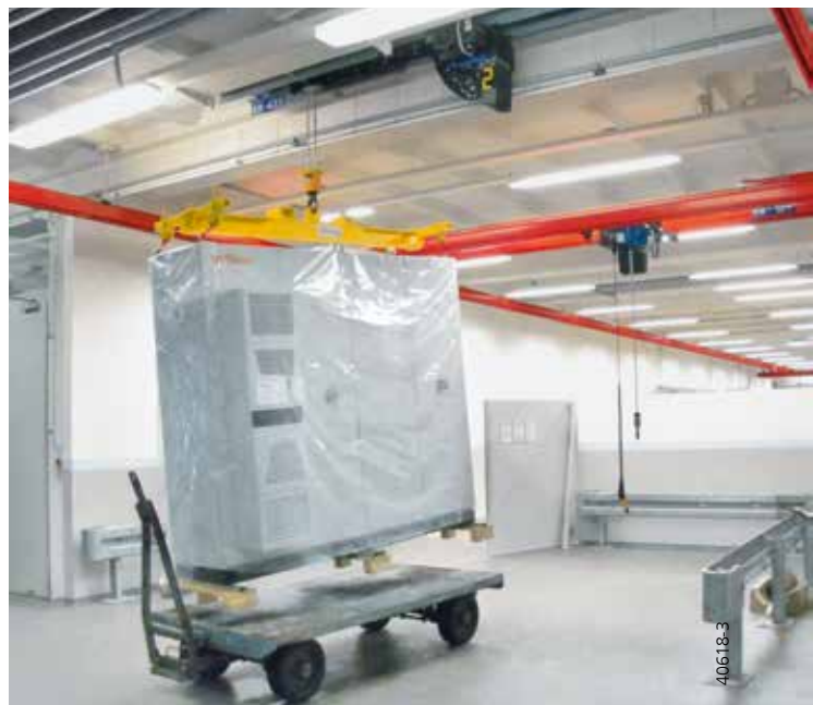
Wózek zwartej budowy KLDC ze zwiększonym odstępem haka od wciągnika (wózek BigBag)
