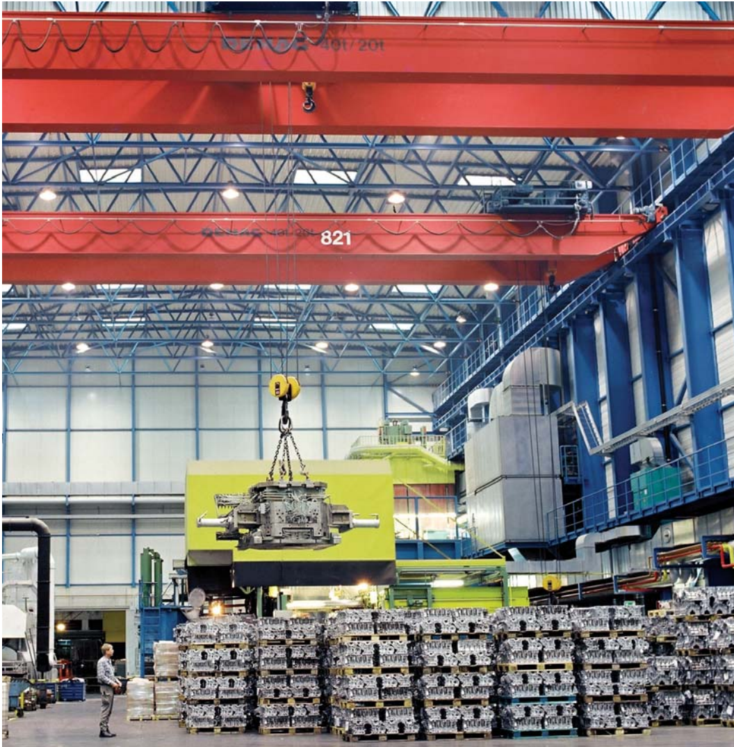
八轮式的双梁桥式起重机可用于吊运和翻转发动机组
