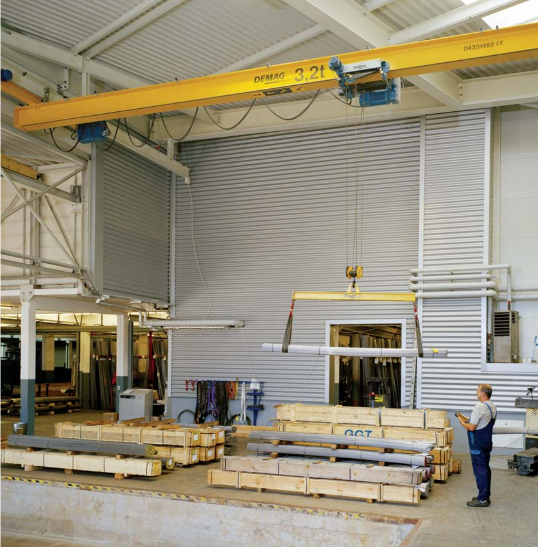
遥控系统方便您在任何方位控制起重机
