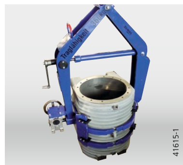
Chwytnik obrotowy 90° (w lewo) i 360° (w prawo) z regulacją wrzecionową i przekładnią samohamowną
