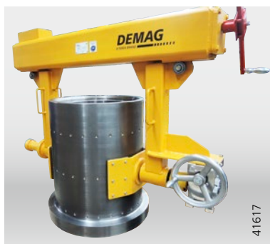
Chwytnik obrotowy 90° (w lewo) i 360° (w prawo) z regulacją wrzecionową i przekładnią samohamowną
