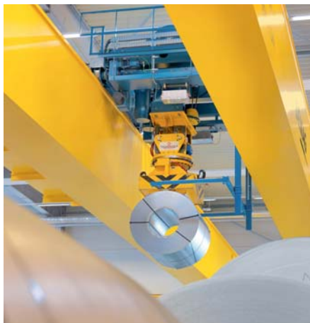
Sichere Aufnahme und exakte Positionierung: Automatisierter Coilmaster-Kran mit Magnettechnik
