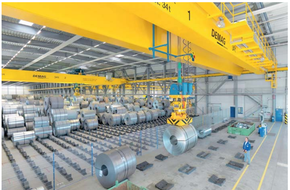
Die angelieferten Coils werden in der Quarantänezone abgelegt und vereinnahmt
