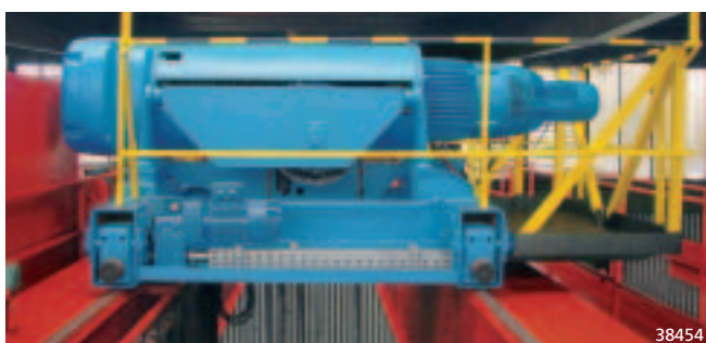
Переоснащение механизма перемещения тележки, а также капитальный ремонт подъёмного механизма
