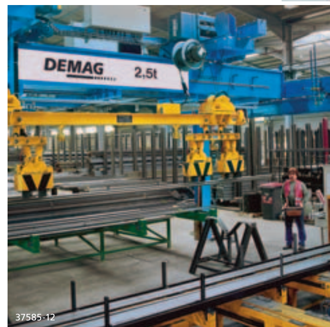
Полностью автоматизированная крановая система Demag Steelmaster – в качестве грузозахватных приспособлений используются магниты и захваты
