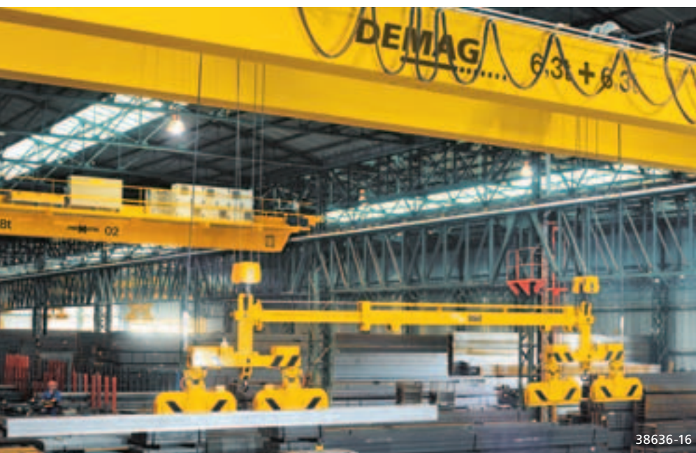
Крановая система Demag Steelmaster с магнитной траверсой для перемещения длинномерных грузов, отдельных компонентов или металлических листов
