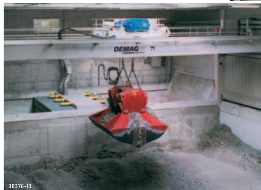
Автоматические технологические краны Demag на цементном заводе
