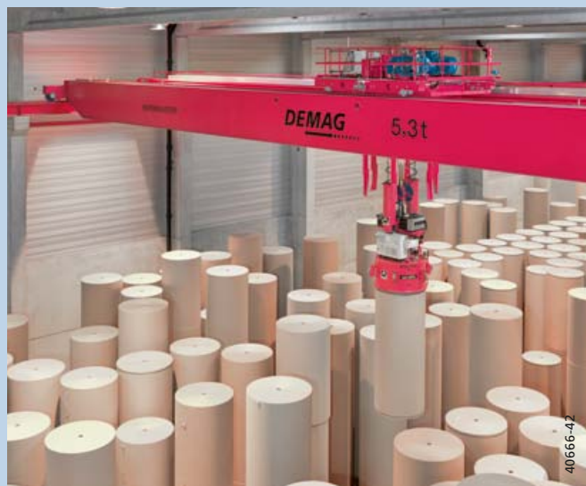
Schonender Transport und Lagerung: Demag Krantechnik mit Vakuumtechnologie
