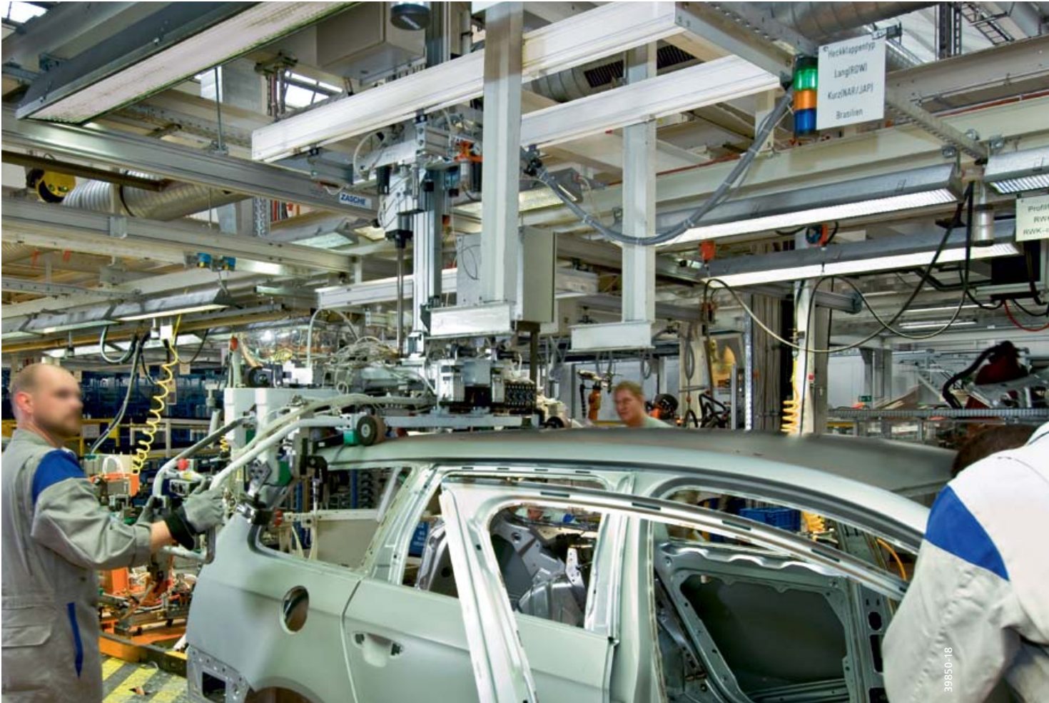
Anlage mit KBK Aluline und Manipulatoren für die Montagelinie in einem Automobilwerk
