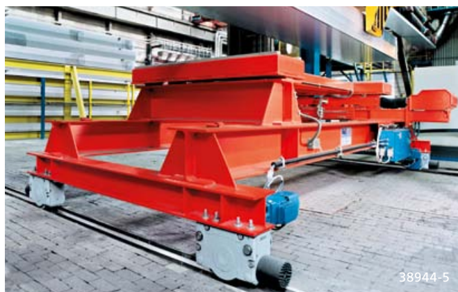
Vierradwagen mit Zentralumrichter zum sanften Verfahren von Aluminiumblöcken
