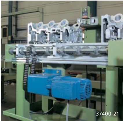
Rollenförderer mit exakt einstellbarer Geschwindigkeit
