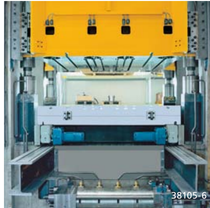
Werkzeugwechselwagen in der Metallindustrie
