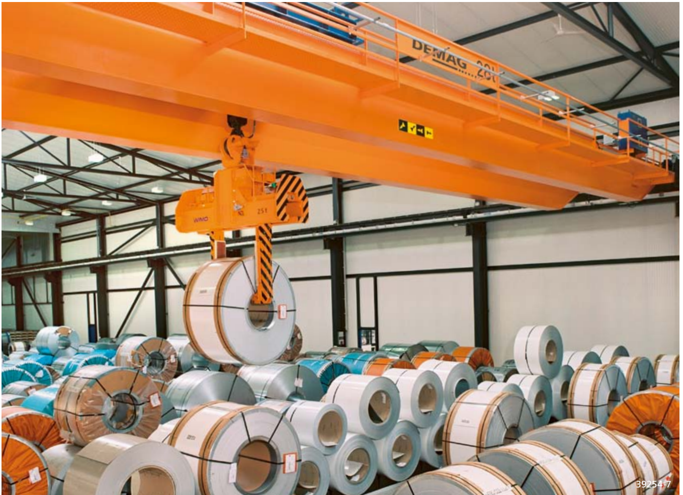
Feinfühlinger Transport von Bandstahl in einem Coil-Lager
