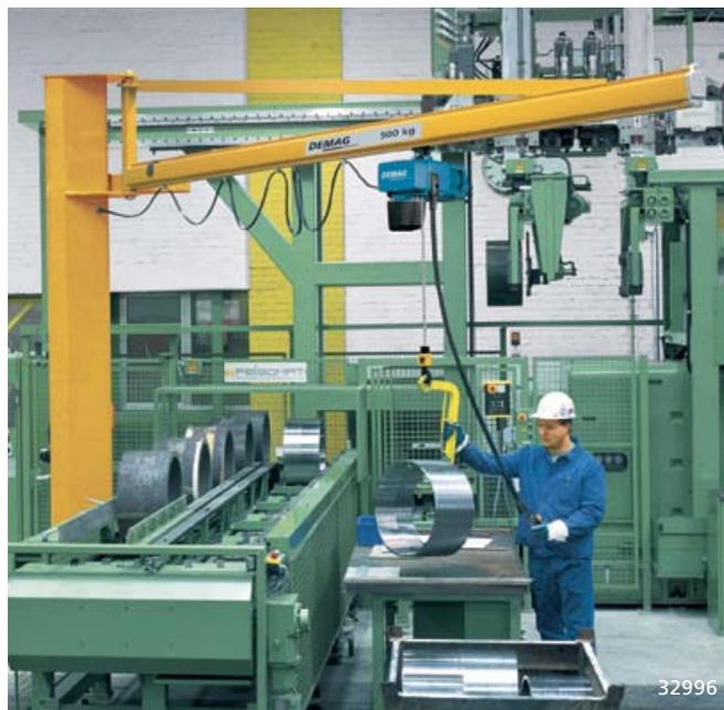
La potence pivotante KBK se caractérise par un poids mort faible, tout en offrant une capacité de charge élevée et une grande portée. Grâce à son poids réduit, la flèche se déplace facilement. La poutre en profilé creux KBK réduit au minimum les efforts de déplacement.
