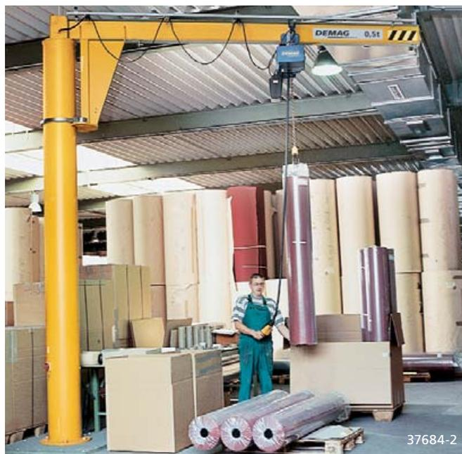
Cette potence constitue une solution polyvalente pour des capacités de charge moyennes jusqu'à 5.000 kg. La flèche de construction basse permet ici aussi des courses de levage élevées avec un angle de rotation illimité. Elle existe aussi avec un mécanisme de rotation à commande électrique, pour un meilleur confort d'utilisation.
