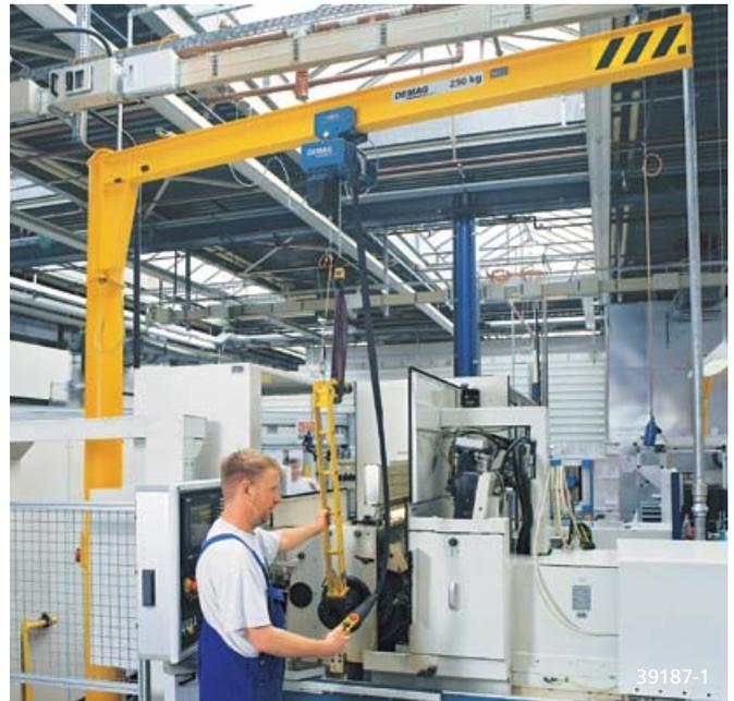
Grâce à sa construction légère et à sa flèche basse, cette potence universelle peut être utilisée pour des capacités de charge moyennes jusqu'à 2.000 kg.
