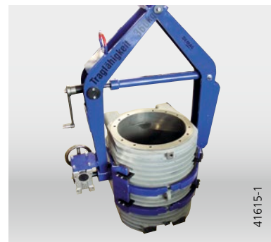
Wendegreifer 90° (links) und 360° (rechts) mit Spindelverstellung und selbsthemmendem Getriebe
