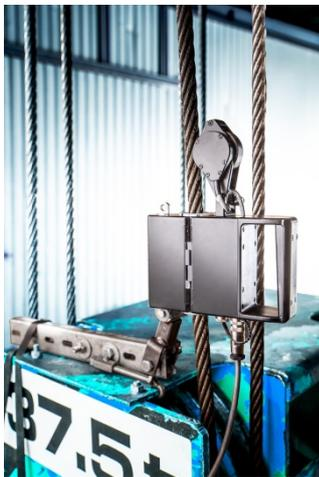
Induktive Seilprüfung: Ein neuer Dienst der Demag Service Seilprüfung
