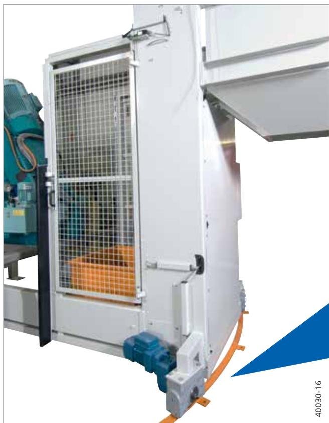
Il motore per traslazione Demag ZBF a massa volante aumentata, consente accelerazioni e decelerazioni dolci nel funzionamento con alimentazione direttamente dalla rete.
