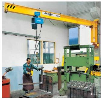
Благодаря расчету для цепной тали Демаг или канатной тали Демаг в сочетании с низко работающей стрелой и большой грузоподъемностью настенный поворотный кран D-GW обеспечивает универсальный спектр применения.
