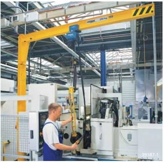
Благодаря легкой конструкции и низко работающей стреле данный консольный кран с поворотной стрелой на колонне имеет универсальное применение в среднем диапазоне нагрузки до 2000 кг.
