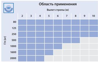
Настенный поворотный кран D-AW имеет универсальное применение в среднем диапазоне грузоподъемности до 2000 кг. Низкий собственный вес делает возможным легкий поворот стрелы также и с грузом. Благодаря низкой высоте конструкции он может использоваться также и там, где несмотря на низкую высоту потолка требуется большой ход крюка.
