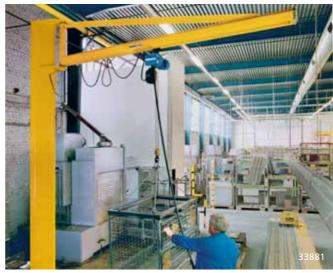
Консольные краны с поворотной стрелой КВК убеждают своей большой по отношению к собственному весу грузоподъемностью и вылетом стрелы. Благодаря малому весу стрела легко поворачивается, а использование полого профиля КВК в качестве опоры крана обеспечивает минимальные усилия передвижения.
