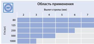
Поворотные деррик-краны дают решающее преимущество там, где передвижению стрелы не мешают стены, опоры или подобные элементы: Область поворота простирается на n x 360°. Поворотный деррик-кран D-GS для нижнего диапазона грузоподъемности до 1000 кг особенно убеждает в свою пользу за счет малой высоты конструкции и компактных размеров. Идеален везде, где имеется ограниченная высота потолка, но требуется максимальный ход крюка.
