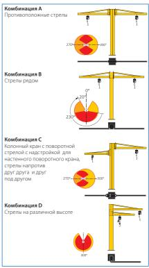
Эффективное решение в виде консольного крана с поворотной стрелой на колонне с двумя стрелами при такой же занимаемой площади как и у поворотных кранов с одной стрелой. Для совершенной организации рабочего места в наличии имеются четыре различных расположения стрелы. Тем самым можно оптимально рационализировать индивидуальные рабочие процессы и одновременно экономично реализовать их.
