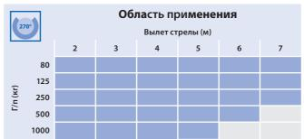
Решающим преимуществом настенных поворотных кранов является то, что им не требуется площадь пола, так как они монтируются на способных нести нагрузку бетонных стенах, опорах цеха или же на станках или оборудовании. При этом установка является особенно простой, так как выполненный в виде готового к монтажу блока кронштейн избавляет от требующей затрат рихтовки. Настенный поворотный кран КВК подходит для нижнего диапазона грузоподъемности до 1000 кг.
