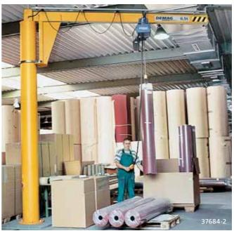
Этот поворотный кран представляет собой решение широкого профиля для среднего диапазона нагрузки до 5000 кг. Низко работающая стрела делает возможным и в данном случае особенно большой ход крюка при неограниченном угле поворота. Для комфортного обслуживания при комплектации по заказу может эксплуатироваться с электрическим механизмом поворота.
