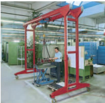
Les portiques roulants KBK sont constitués des éléments de l'ensemble modulaire KBK Demag. La flexibilité de ce système modulaire permet de concevoir les formes d'installation les plus diverses et d'élaborer des solutions spécifiques. L'utilisation de pièces standards contribue en outre à raccourcir les délais de livraison.
