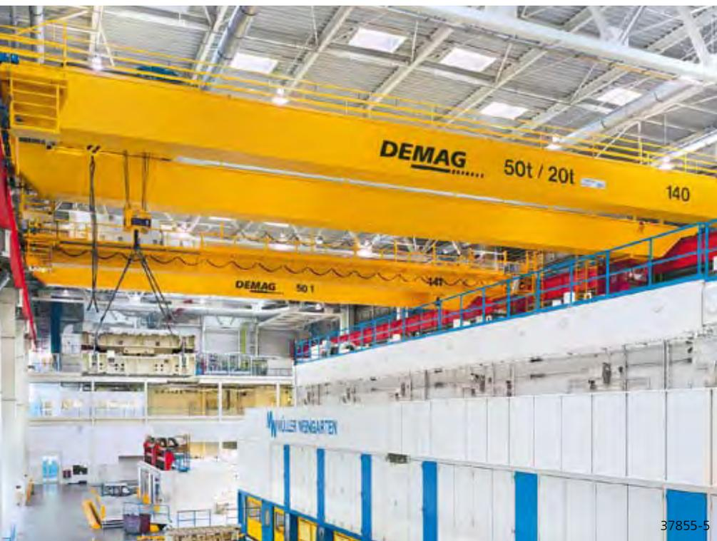
Ponts process Demag dans un atelier de presses dans l'industrie automobile. Ces ponts sont utilisés pour le changement d'outils.
