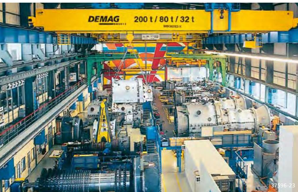
Des ponts process Demag transportent avec une précision de l'ordre du millimètre des pièces usinées pesant jusqu'à 200 t dans le cadre de la fabrication de turbines et de générateurs
