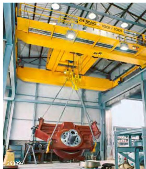
Des ponts spéciaux sont utilisés dans la production de pièces de concasseurs pour retourner les pièces
