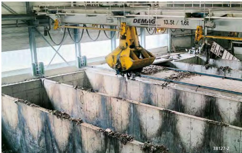
Dans une usine de traitement des ordures ménagères, les ponts process Demag assurent le remplissage en mode entièrement automatique de fosses remplies de déchets résiduels.
