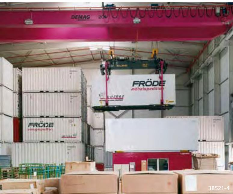
Des systèmes de gestion des stocks et des ponts process Demag « intelligents » assurent une utilisation optimale de l'espace disponible
