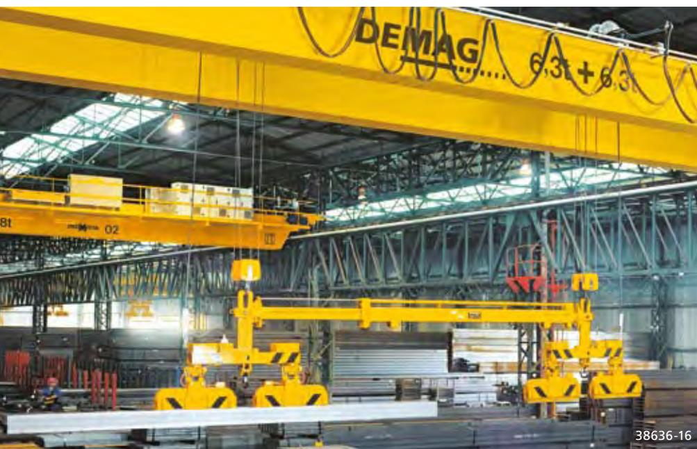
Pont « Steelmaster » équipé d'un palonnier à électro-aimants pour la prise de charges longues, de pièces unitaires ou de tôles
