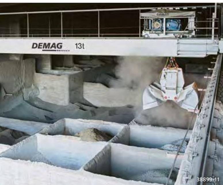
Remplissage et prélèvement entièrement automatique des différents agrégats à l'aide d'un pont automatique Demag dans une cimenterie
