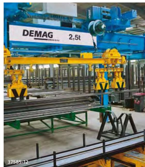
Pont « Coilmaster » muni d'aimants ou de pinces comme moyens de préhension, travaillant dans un magasin de coils entièrement automatique
