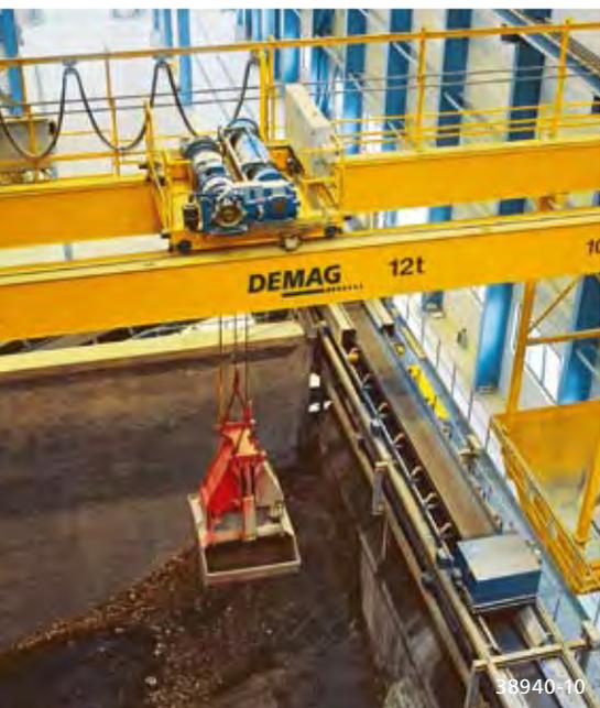
Ponts process Demag dans le secteur du recyclage et du traitement des ordures ménagères
