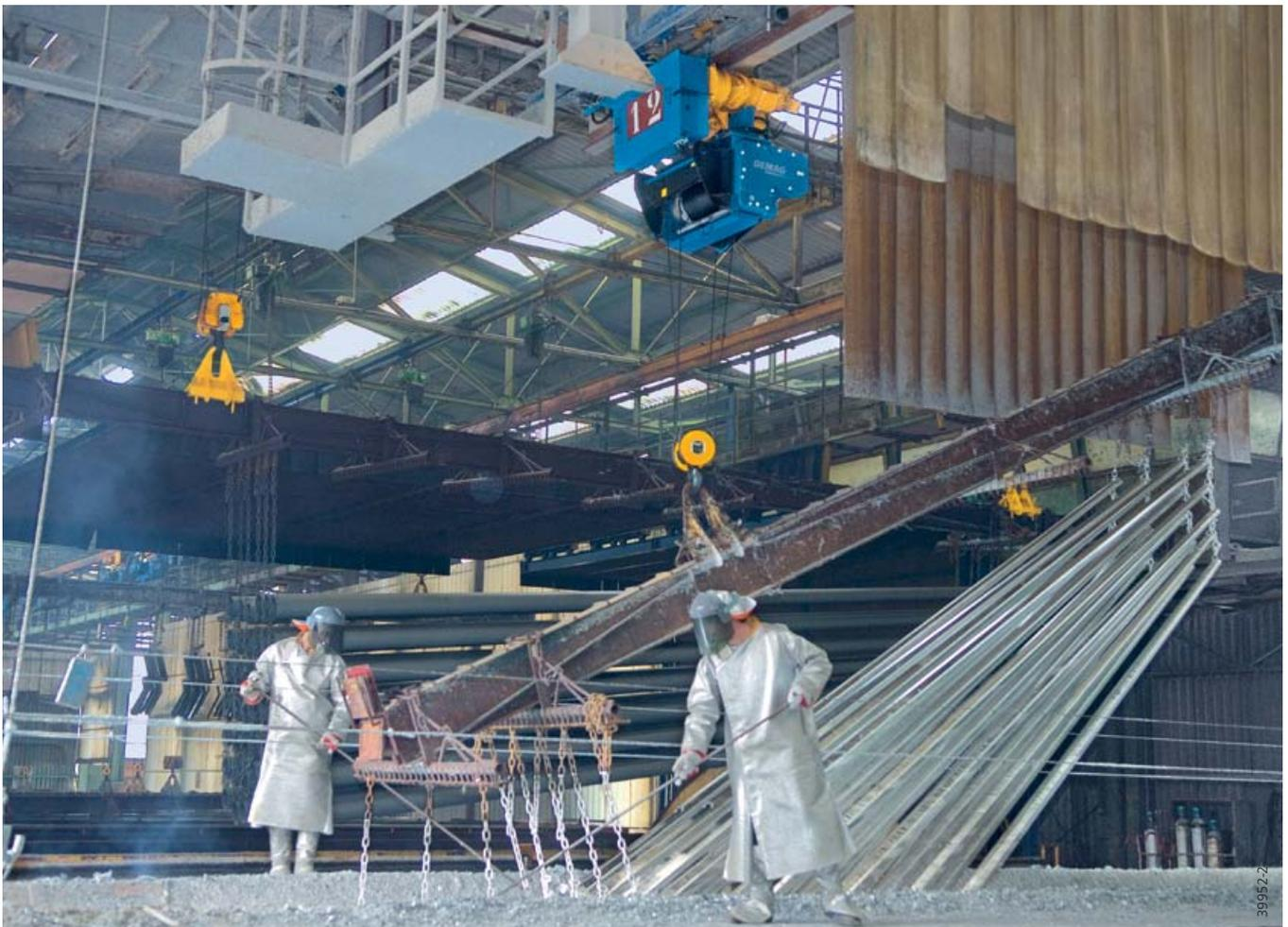
Des palans à pattes FDR Demag circulent sur une voie en circuit fermé semi-automatique dans un atelier de galvanisation.
