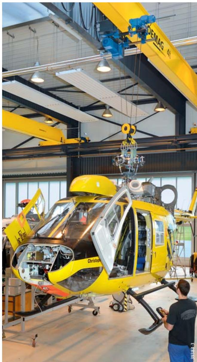
Palans à câble Demag utilisés pour le positionnement d'un hélicoptère en vue de sa maintenance
