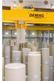
Zuverlässiger Einsatz im 24/7-Betrieb: Demag Prozesskrane mit Vakuumgreifer für das Handling von unverpackten Papierrollen.
